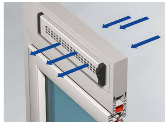
SECCOVARIO – Il sistema di aerazione variabile
