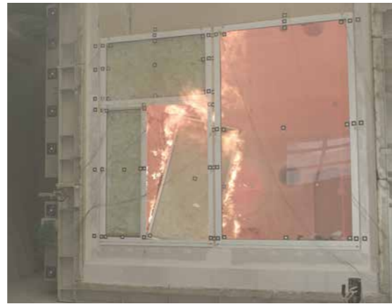
Finestre ignifughe EgoKiefer testate EI30, garantiscono una resistenza al fuoco per almeno 30 minuti.
