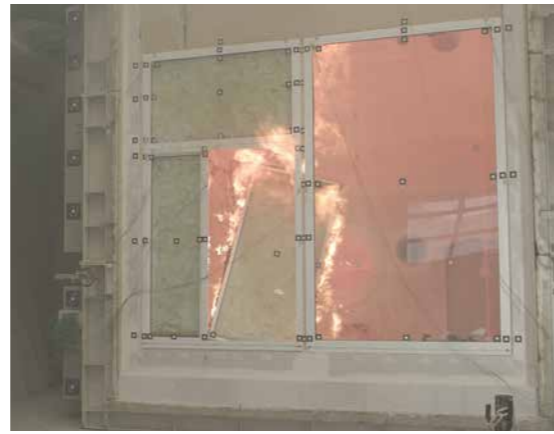
La fenêtre coupe-feu EgoKiefer, contrôlée selon EI30, garantit une protection incendie durant au moins 30 minutes.
